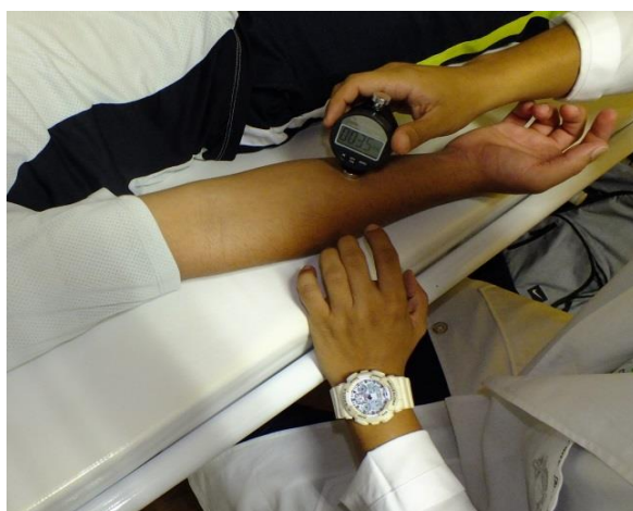
Figura 3. Posicionamento do durômetro na intersecção das linhas bissecionais do antebraço
